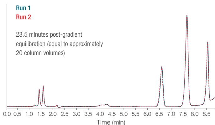
**Synchronis HILIC column, 5  $\mu$ m, 100  $\times$  2.1 mm**
